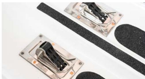
Vides-vite pour l'évacuation de l'eau
